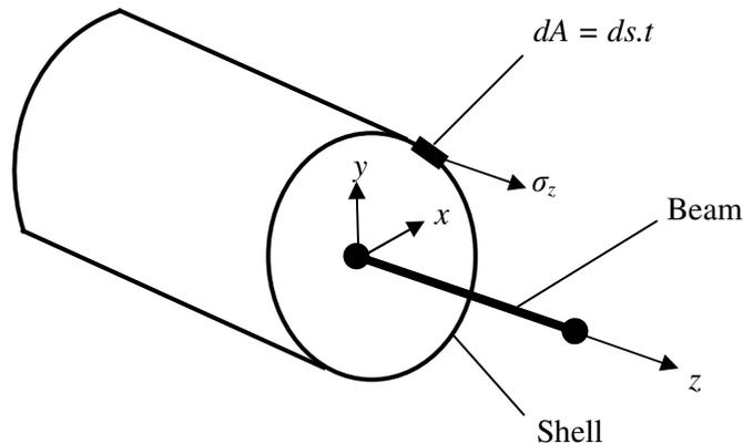
Fig. 4-1 Beam-Shell Coupling
